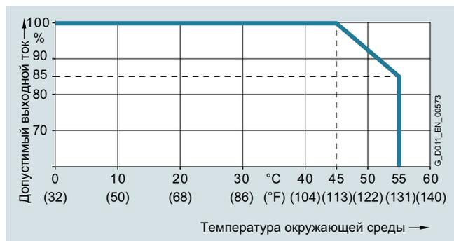
Допустимый выходной ток в зависимости от температуры окружающей среды для SINAMICS G120X, типоразмеры FSH и FSJ, для низкой перегрузки (LO)
