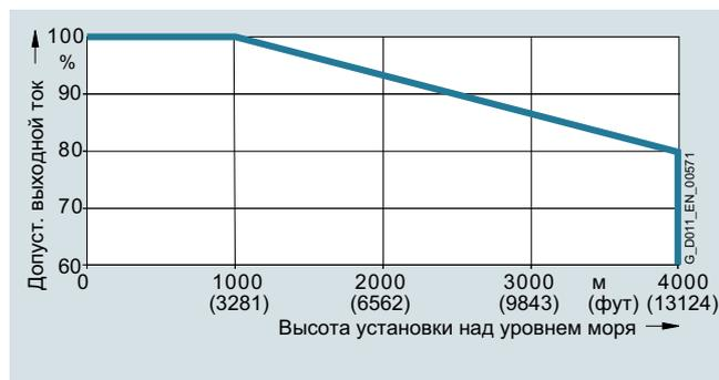
Допустимый выходной ток в зависимости от высоты места установки для SINAMICS G120X, для низкой перегрузки (LO)
