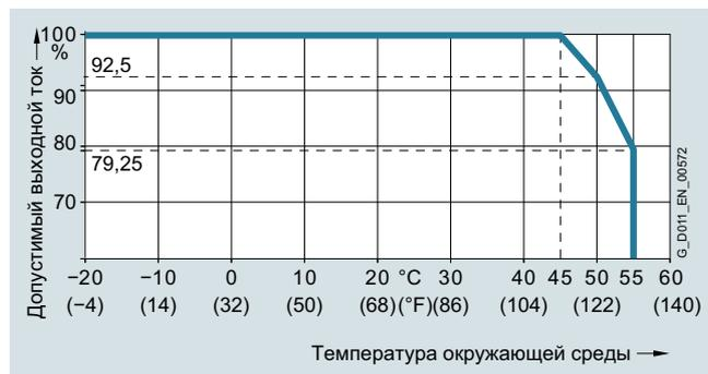
Допустимый выходной ток в зависимости от температуры окружающей среды для SINAMICS G120X, типоразмеры от FSA до FSG, для низкой перегрузки (LO)
